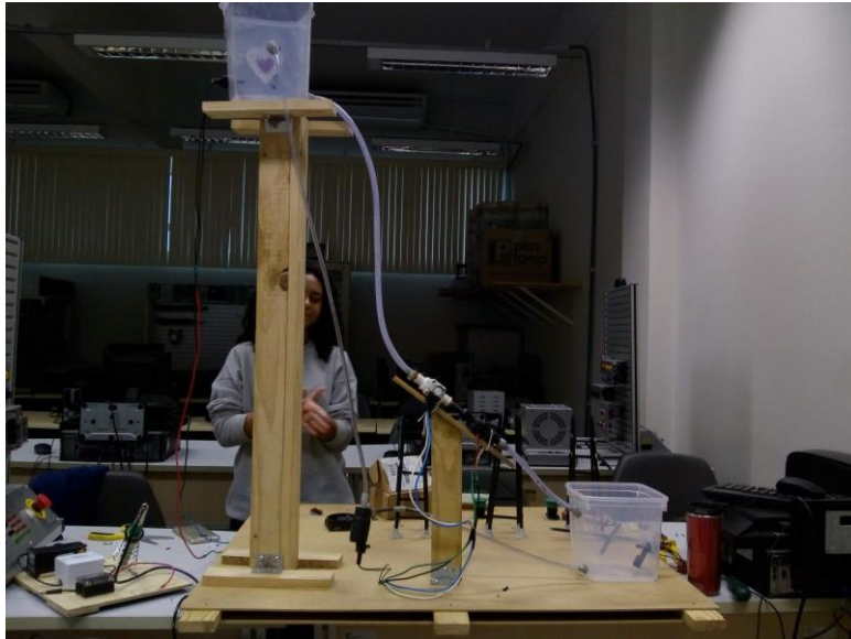
Fig:10 - Protótipo 2.0 com o tamanho dos suportes do reservatório e da válvula e do gerador corrigidos;
